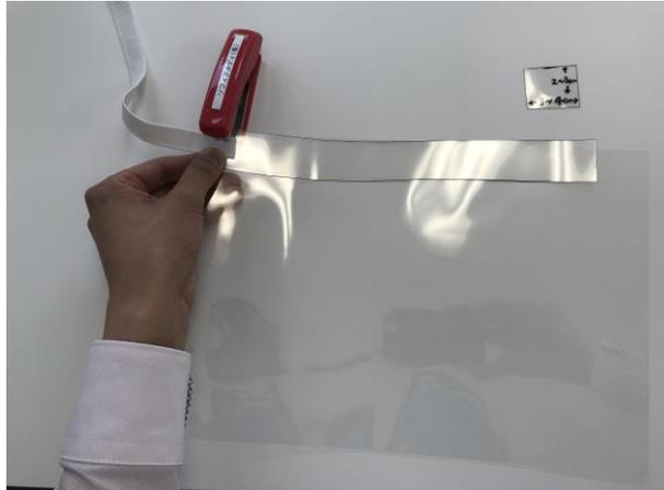
カットしたラミネートフィルムとゴムを束ねて、ラミネートシートの端にホチキスで止めます
